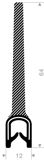
245.00.890 PVC + Vollgummi Spannbereich 1,5-4 mm
